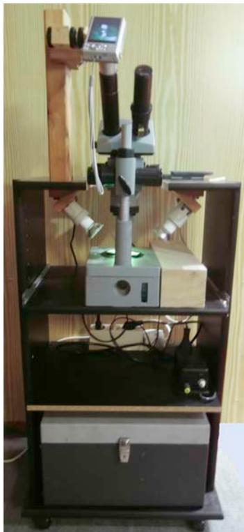
**Abb. 7:** Fotografieren durch den Binokular-Tubus.
