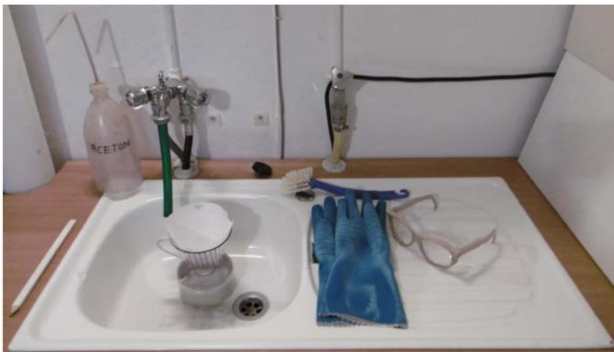
**Abb. 3:** Aufbau der Probenspülung.
