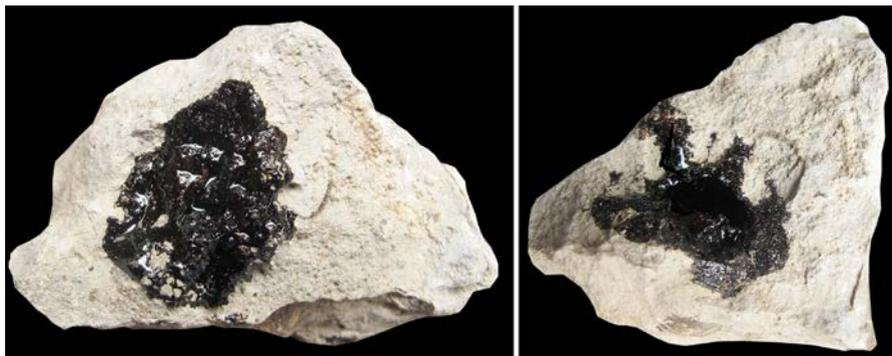
**Abb. 3:** Bitumen (Erdpech) im Sediment; links: Breite 50 mm, rechts: Breite 30 mm
