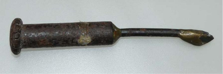
**Abb. 1:** Werkzeug eines professionellen Präparators aus den siebziger Jahren, die Hartmetallspitze des zusammengeschweißten Werkzeugs stammt von einem Fräskopf.
